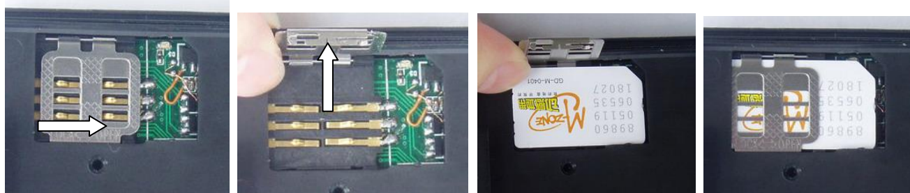
1. Pousser le capet longitudinalement et le lever.
